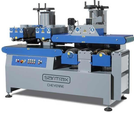
ÜRETİM ESNASINDA WOOD PLASTİK ÜRÜNLERİ ÜZERİNE ZİMPARA APARATI İLE ESKİTME İŞLEMİ MAKİNE ÜRETİMİ SATIŞ / AGING PROCESS WITH SANDING DEVICE ON WOOD PLASTIC PRODUCTS DURING PRODUCTION MACHINE PRODUCTION SALES
